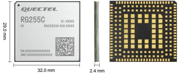
移远通信 RG255C 系列是一款 LGA 封装的 5G RedCap Sub-6 GHz 模块。模块采用 3GPP Rel-17 RedCap 技术，支持 5G LAN\*/ URLLC/ 网络切片，理论下行峰值速率可达 223 Mbps，理论上行峰值速率可达 123 Mbps。模块支持 LTE Cat 4 和 5G Sub-6 SA 模式，向下兼容 3GPP Rel-15 和 Rel-16 网络。同时，模块与移远通信 EG2x 系列部分模块尺寸兼容，可以满足客户对中速度、大容量、低延迟、高可靠性等要求，便于客户设计。
