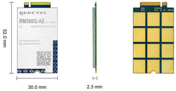
移远通信 RM500Q-AE 是一款专为 IoT/eMBB 应用而设计的 5G Sub-6 GHz 模块。采用 3GPP Release 15 技术，同时支持 5G NSA 和 SA 模式。RM500Q-AE 采用 M.2 封装，与移远通信 LTE-A Cat 6 模块 EM06、Cat 12 模块 EM12-G、EM120R-GL 和 EM121R-GL，以及 Cat 16 模块 EM160R-GL 兼容，方便客户从 LTE-A 迁移到 5G。
