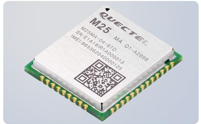
M25 是一款超小的四频 LCC 封装 GSM/GPRS 模块, 尺寸仅为 17.7mm×15.8mm×2.4mm, 能最大限度地满足终端产品对小尺寸模块产品需求, 有效帮助客户减小产品尺寸并优化产品成本。
